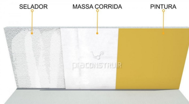
Figura 3 - Ilustração Aplicação Fundo Selador, Massa Corrida e Pintura (fonte: Autora/2020)
