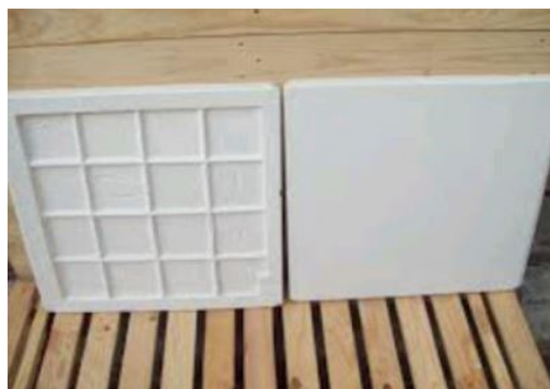
Figura 4 - Ilustração da placa de Gesso Utilizada no Projeto (Fonte: Autora/2020)
